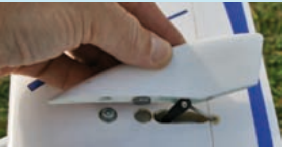
Die Finne als Seitenruderfortsatz wird durch einen Magneten auf dem HLW gehalten. Wichtig ist dabei, dass das Halteplättchen im HLW spaltfrei zum Magneten eingeklebt wird.
