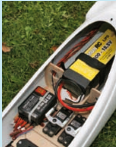
Der Akku ist auf der Akkurutsche gut zugänglich und braucht nur mit einem „Klett-Kabelbinder“ gesichert werden.
