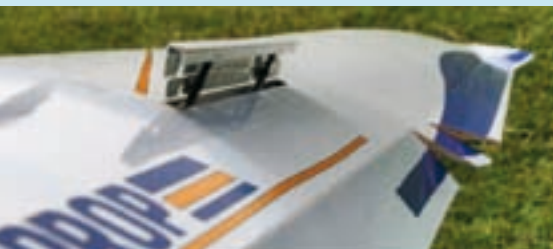
Das bremsst richtig: Doppelte Störklappen + Butterfly von Querruder und Wölbklappen.
